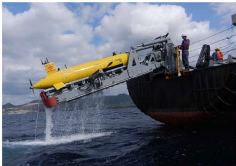
AUVの投入・揚収装置 (LARS)
